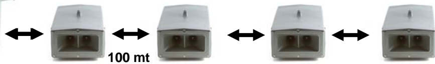
max. 5 AP203 luidsprekers op AM104 versterker
